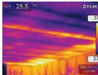
El Termómetro Laser Infrarrojo detecta las entradas o salidas de calor. Enciéndalo y apúntelo a un lugar con el potencial de dar problemas en su casa. Fíjese en cualquier fluctuación de la temperatura que pudiera ser causada por fugas de aire.
